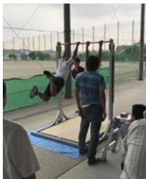
ぶらさがりによって発生する力の計測実験
